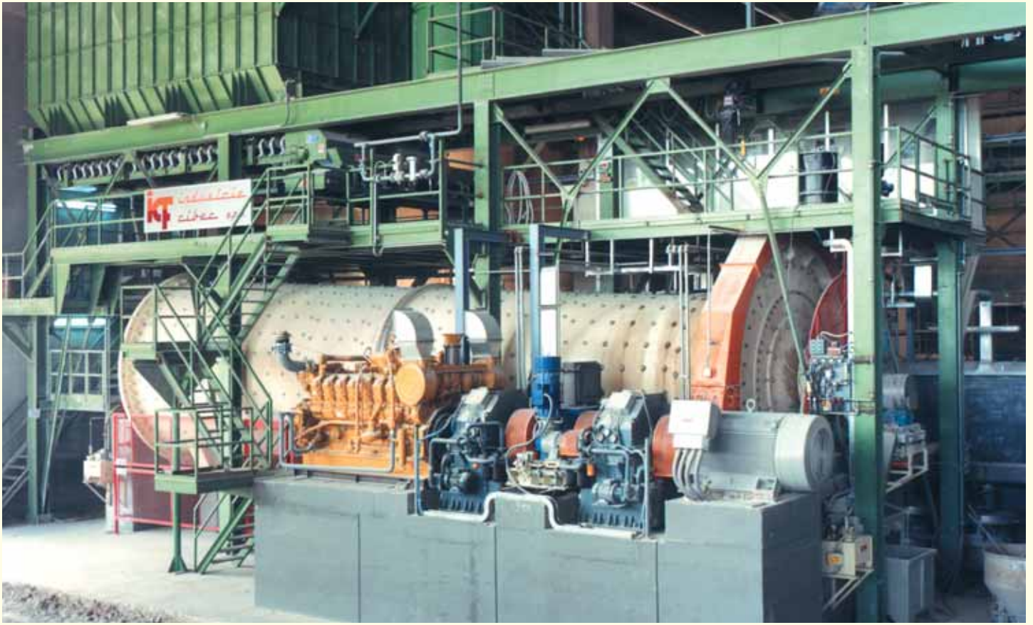
2x34 KSL, 630 кВт - 1000 об/мин. Мельница для помола керамики (Италия)
